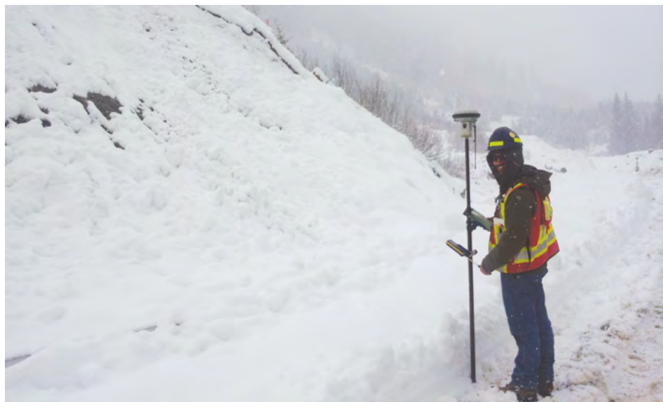
Un travail d'arpentage hors de danger : mesurer un terrain escarpé à partir d'un endroit sûr, dans les périlleuses montagnes du magnifique nord de la Colombie-Britannique, au Canada.
