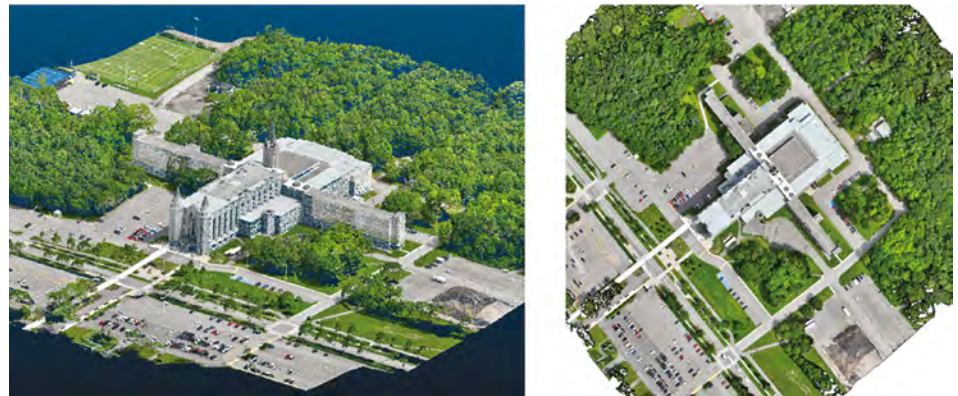
Figure 4 – Extraits du nuage de points (gauche) et de l'ortho-image (droite) du secteur du pavillon Louis-Jacques-Casault. Les produits sont générés à partir des données acquises avec le Mavic 3E.
