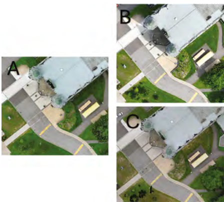
Figure 11 – Extraits des ortho-images du secteur du pavillon Louis-Jacques-Casault. A a été produit par l'EVO II Pro, B par le Mavic 3E et C par le mdMapper1000DG.
