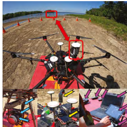
Figure 2 – En haut : drone équipé d'un parachute; en bas à gauche : nacelle stabilisée et caméra reflex avec une lentille de 135 mm; en bas au centre : système GNSS RTK avec son antenne; en bas à droite : télécommande avec tablette, ordinateur, télécommande pour la nacelle, télécommande pour le parachute et radio d'écoute des ondes radio d'aviation
