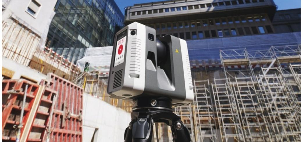
En effet, lorsque vient le temps de déplacer le RTC360 vers la prochaine station, tous les capteurs mentionnés ci-haut s'activent et commencent à enregistrer automatiquement des points de contrôle. C'est de cette façon qu'au fil de ses déplacements, le RTC360 parvient à faire lui-même l'alignement des nuages de points, autant pour les axes « X », « Y » que « Z ».
