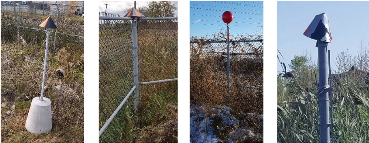
Figure 2 : De gauche à droite : balise conique, balise pyramidale à base triangulaire, balise sphérique et balise endommagée après une saison
