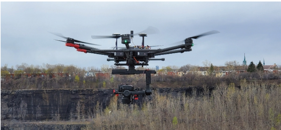
Figure 3 : Drone DJI Matrice 600 Pro équipé d'une nacelle, d'une caméra Nikon 8500 et d'une antenne GNSS
