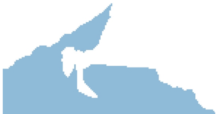
Conversion de format matriciel à vectoriel. Résultat brut avant le traitement de lissage et de simplification pour adoucir l'effet d'escalier causé par la conversion des données matricielles en données vectorielles.
