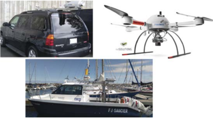
Figure 2 : Différentes plateformes avec SLM : véhicule routier avec Trimble MX2, drone avec Microdrones mdMAPPER1000DG et navire avec Trimble MX2
