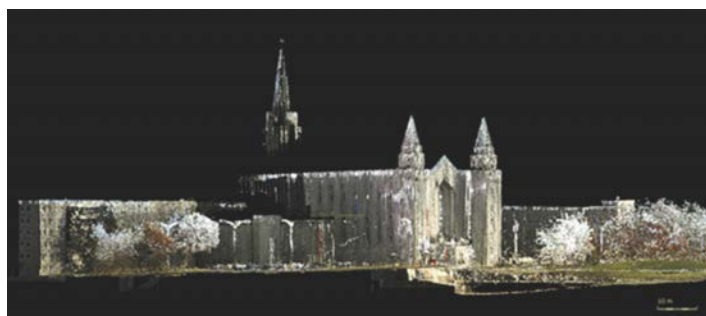
Figure 1 : Nuage de points colorié du pavillon Louis-Jacques-Casault levé avec le MX2 et la caméra Ladybug3
