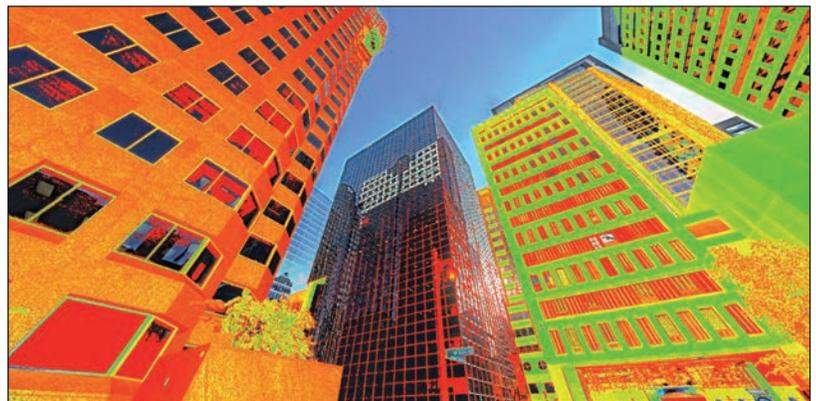
Assemblage d'un nuage de points en intensité et des images prises simultanément par un scanner
