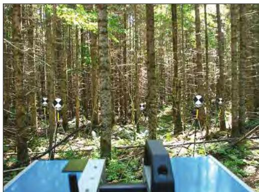
Acquisition en forêt avec un lidar terrestre (Z+F). Les cibles servent à la reconstitution de la scène par alignement des différents points de vue.
