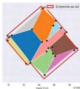
Figure 8 : Exemple de l'algorithme de détection des formes de toits à partir de données générées par lidar aérien : en haut à gauche, le pourtour du toit (ligne rouge) et les points lidar (en bleu); en haut à droite, le pourtour du toit par rapport à l'imagerie; en bas, trois étapes de détection menant à la détection des différents plans composant le toit (à droite)
