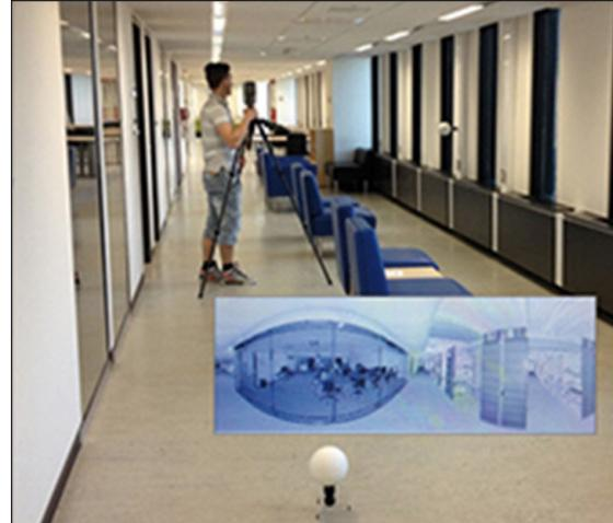
Figure 1. Numérisation 3D du Centre GéoStat avec un balayeur laser TX5 de Trimble
