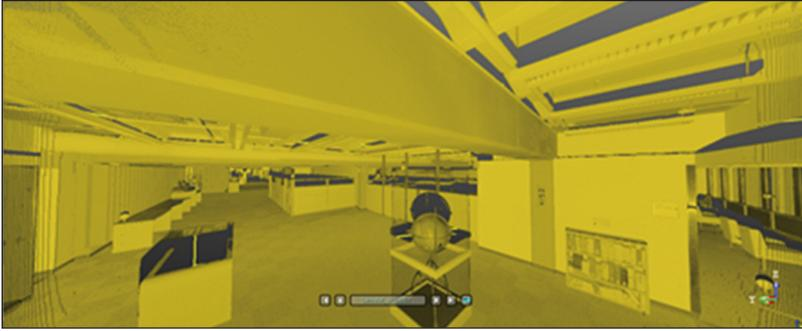
Figure 2. Nuage de points 3D assemblé dans Trimble RealWorks 10.1 : représentation des points en couleur uniforme (en haut) ou en couleur vraie issue des photos acquises avec le balayeur laser (en bas)
