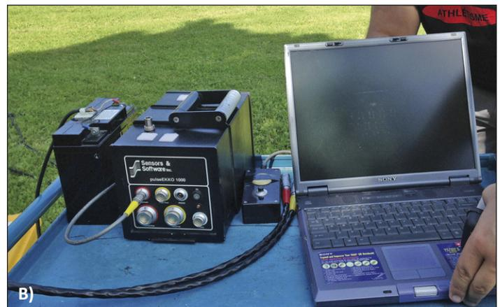
Figures 2. Géoradar pulseEKKO 1000 A) le montage sur roues, B) l'enregistreur
