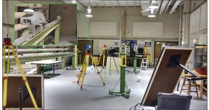
Figure 5 : Montage mis en place pour le calibrage *in lab* d'un MX2
